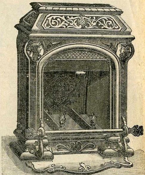
**Cheminée style moderne,** modèle riche, foyer à bois, intérieur briques réfractaires qui reçoivent directement la chaleur et l'emmagasinent. L'air entrant par des bouches ménagées dans le bas de la cheminée, circule autour de ces briques et se répand dans la pièce par des bouches placées à la partie supérieure. Tuyau derrière et ovale.
