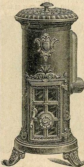
**Calorifère rond tôle et fonte, à feu visible et continu, intérieur briques réfractaires, tuyau en bas, sans entonnoir.**
